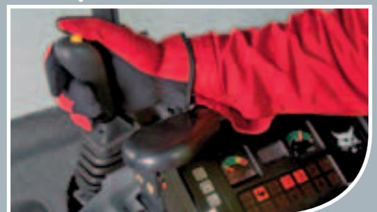
El tercer joystick controla la flotación de la hoja y la segunda velocidad, creando un ambiente de trabajo más cómodo.
