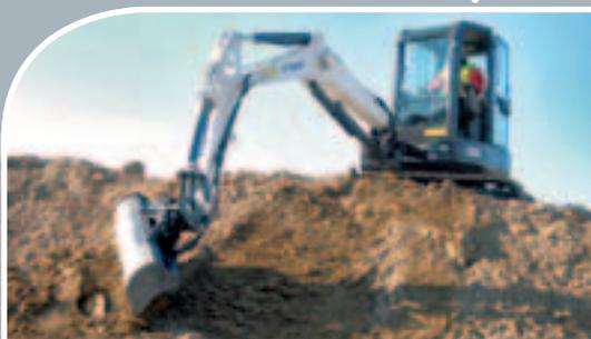
La inclinación del cucharón se controla proporcionalmente con el conmutador basculante del joystick.
